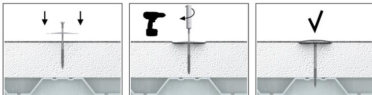
1. Установить шайбу POW на изоляционном материале и вставить шуруп WB
